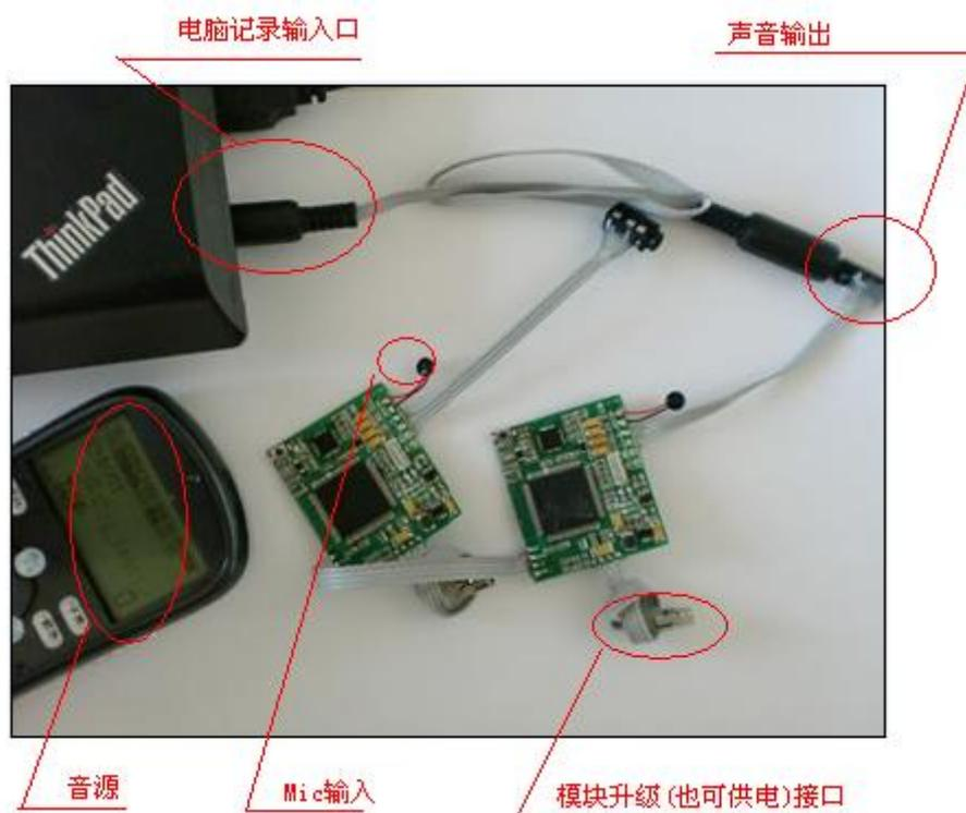
两模块对接测试示意图
